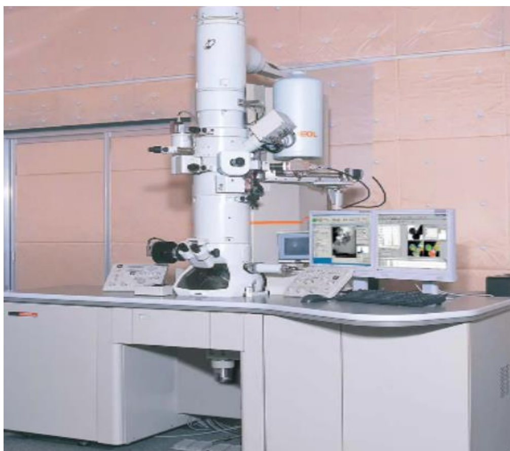
Рисунок 2.3 – Внешний вид просвечивающего электронного микроскопа
