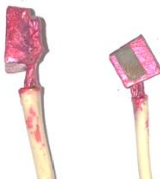
Рисунок 2.11 – Внешний вид рабочего электрода
