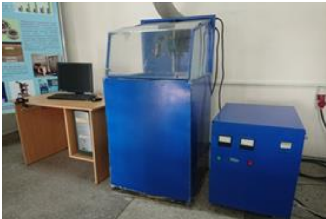
Рисунок 3.1 – Внешний вид экспериментальной установки для проведения электролитно-плазменной обработки материалов
