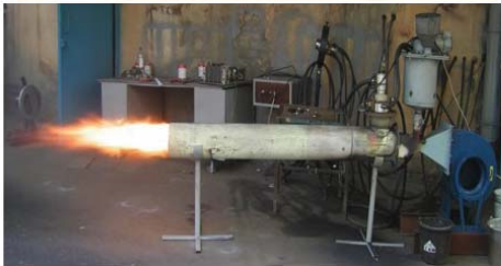
ЖЭС және қазандықтардың энергия тиімділігін арттыруға арналған плазматрон
