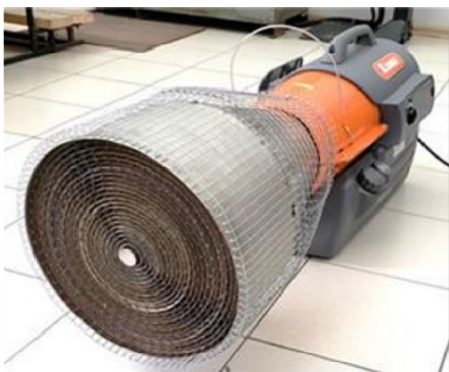
Рис. 2 Каталитические воздушонагреватели на жидком топливе (дизельный) 30 кВт и на газе (пропан-бутан) 15 кВт
