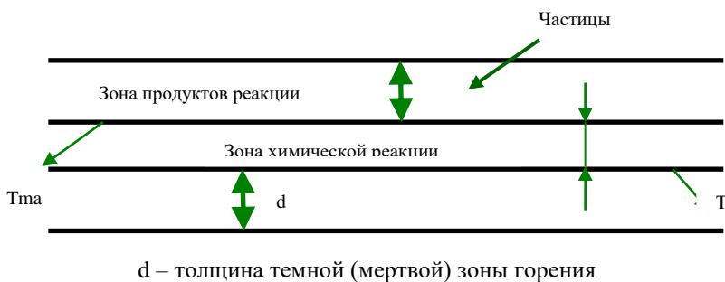
Рисунок 5 - Область горения при сжигании жидкого топлива
