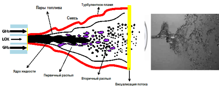
Рисунок 16 - Схема горения распыла
