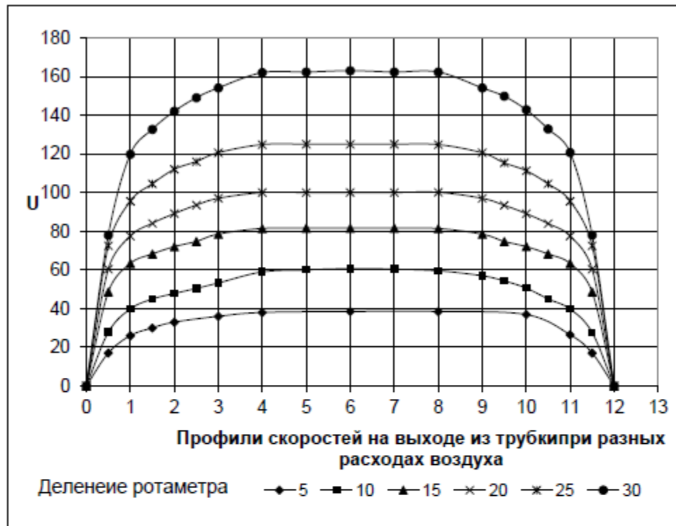
Рис. 3. Данные измерения скоростей при разных делениях ротаметра и соответствующих расходах воздуха
