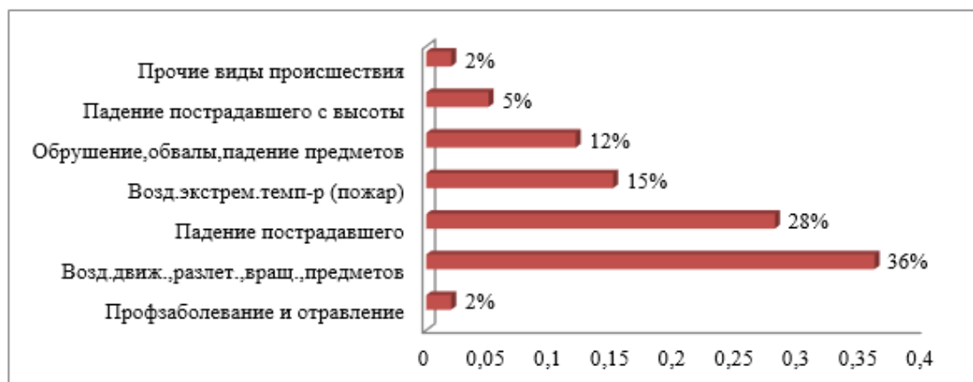
Рис. 5. Распределение доли пострадавших по видам происшествий на предприятиях металлургии обрабатывающей промышленности за 5 лет, %
